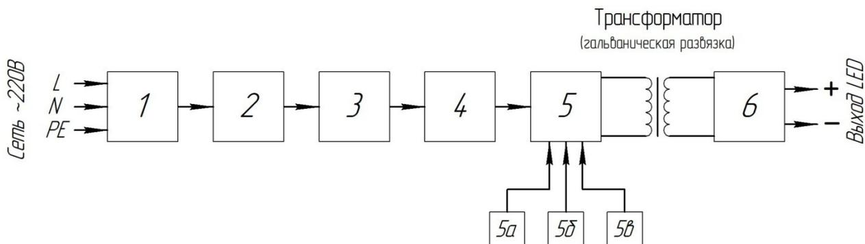
1. Схема защиты от микросекундных импульсов.
